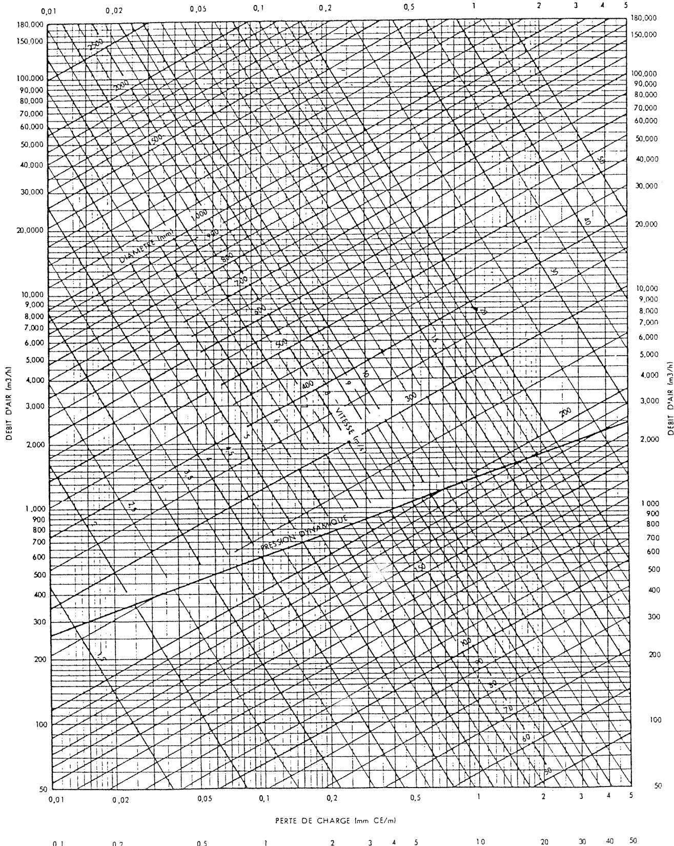
Air à 21° et sous 760 mm Hg, gaines en tôle galvanisée.
